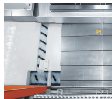
底板沖屑(Vc-F106) + 螺旋式排屑
