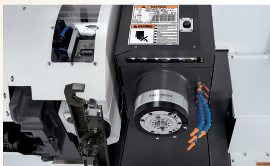
刀臂式ATC + 冷卻液環噴 + LED燈
